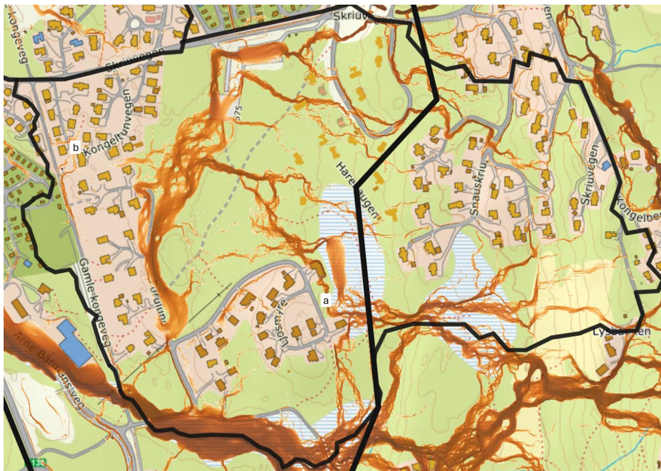
Figur 19 Nærbilde av modellert fluks (strømningsmengde, beregnet som hastighet x dybde) for området ved en 200 års flom.
