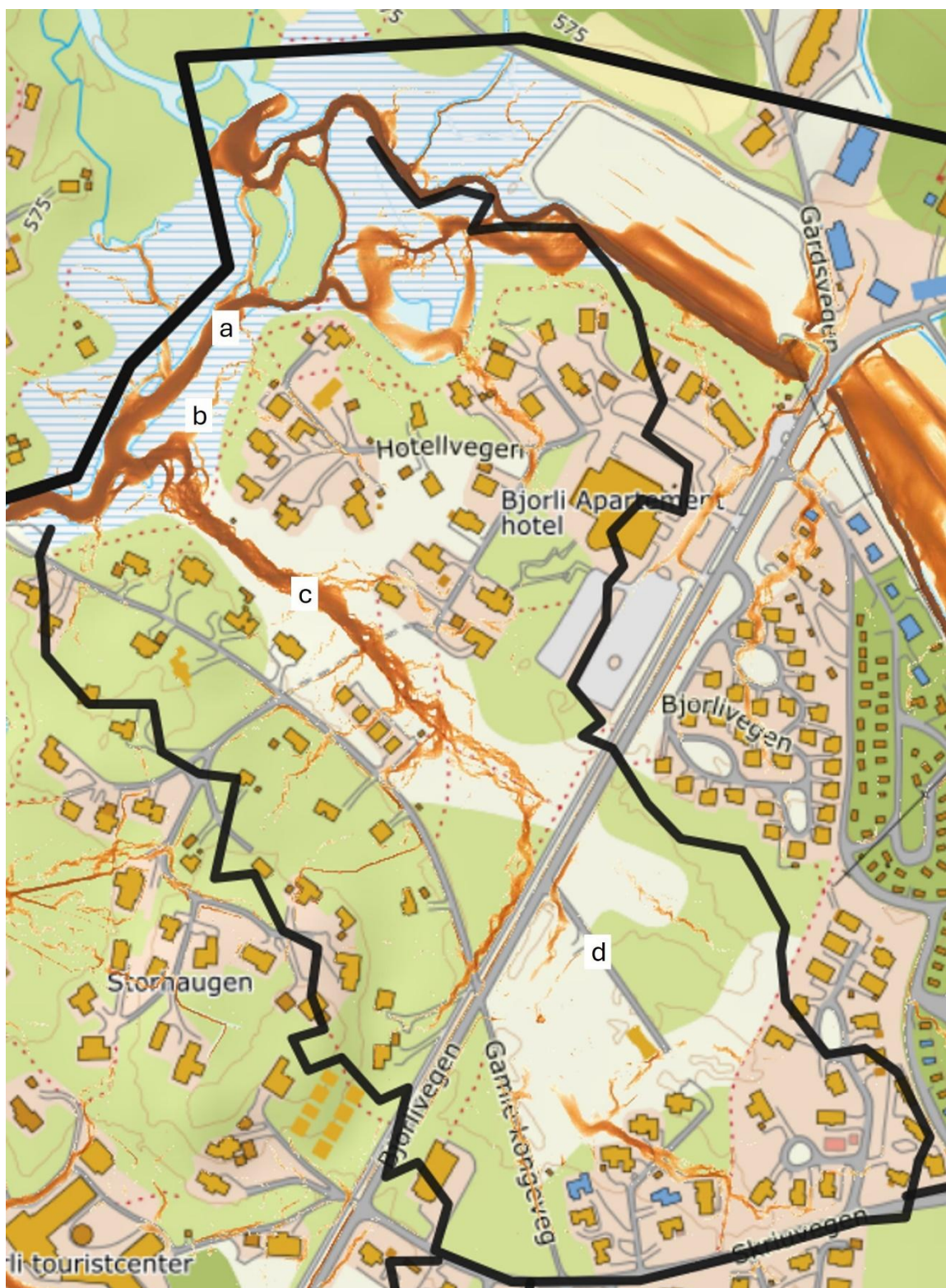
Figur 15 Nærbilde av modellert fluks (strømningsmengde, beregnet som hastighet x dybde) for området ved en 200 års flom.
