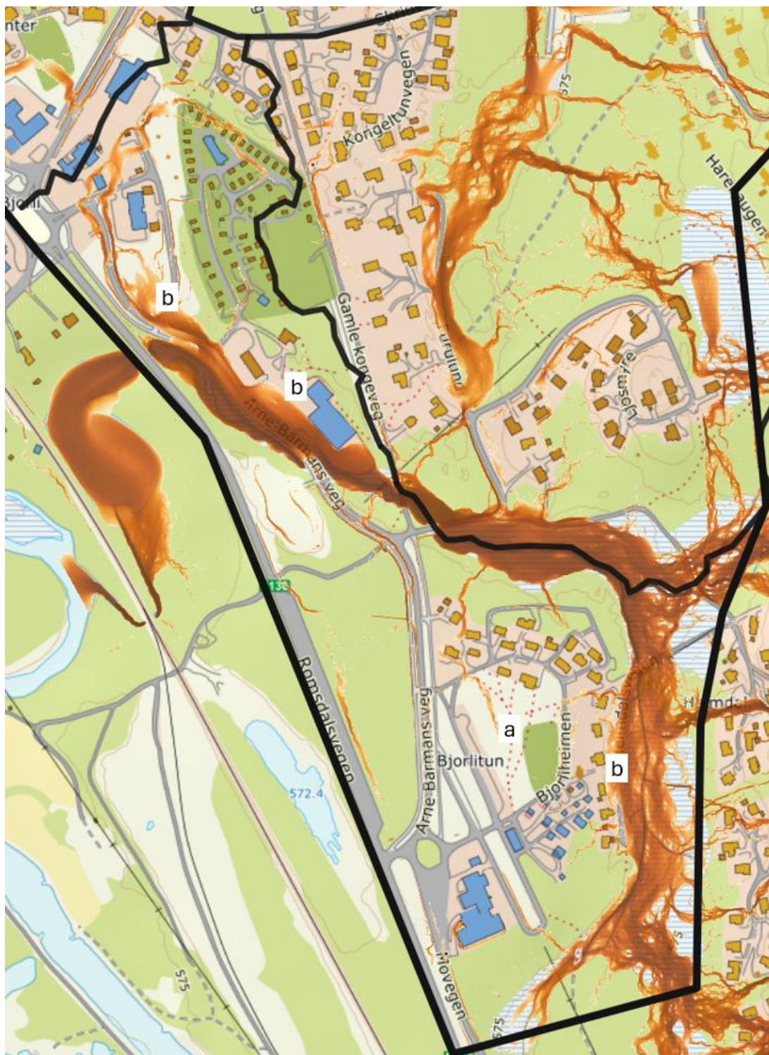
Figur 21 Nærbilde av modellert fluks (strømningsmengde, beregnet som hastighet x dybde) for området ved en 200 års flom.
