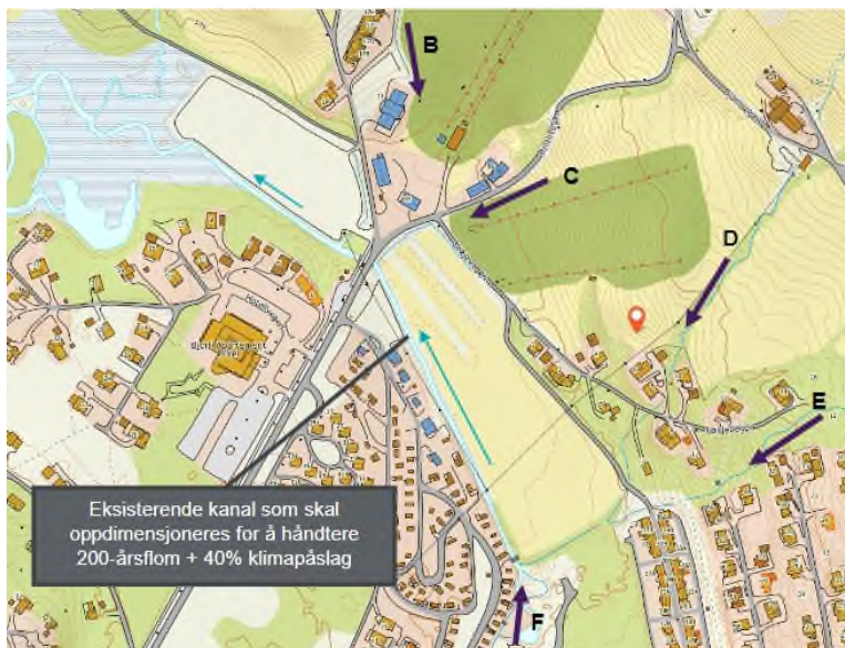
Figur 61. Oversiktskart som viser Bjorli sentrum og kanalen som skal dimensjoneres for 200-årsflom. Pilene angir bekker som ledes til kanalen.
