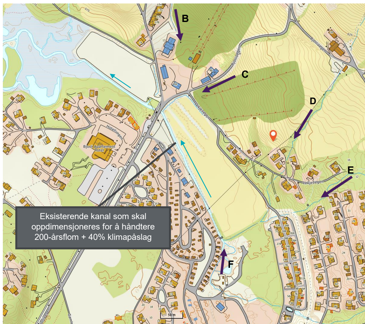
Figur 1: Oversiktskart som viser Bjorli sentrum og kanalen som skal dimensjoneres for 200-årsflom+klimapåslag. Pilene angir bekker som ledes til kanalen.
