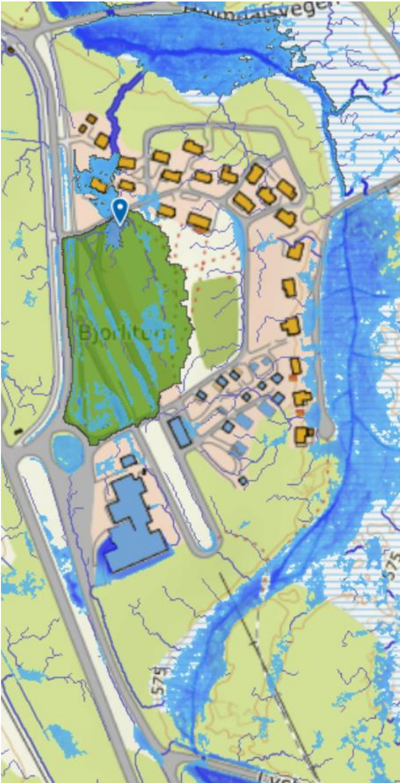
Figur 3: Nedbør-/avrenningsfeltet til bekken forbi planområdet; fra bruk av analyseverktøyet Scalgo.
