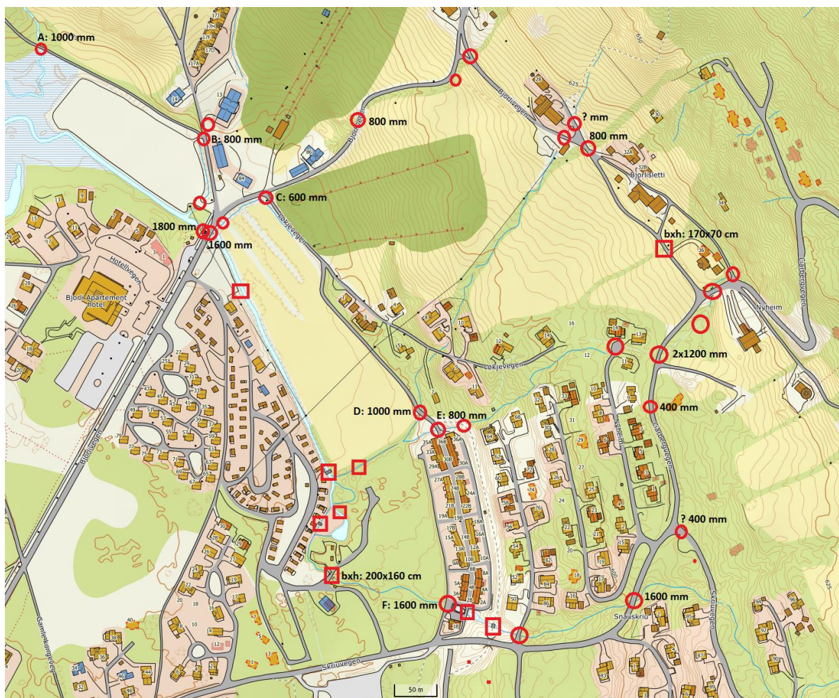
Figur 4: Oversikt over kartlagte stikkrenner (røde sirkler) og bruer (røde firkanter) i sørlige del av området.
